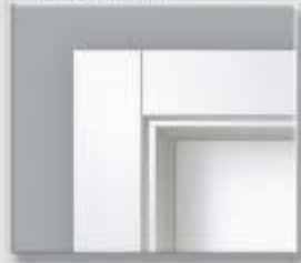
Konstruktionsfuge (stumpf gestoßen)
