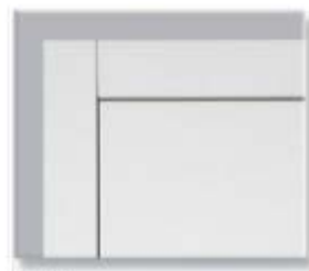
Detail Futter stumpf gestoßen
