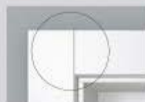
Konstruktionsfuge (stumpf gestoßen)
